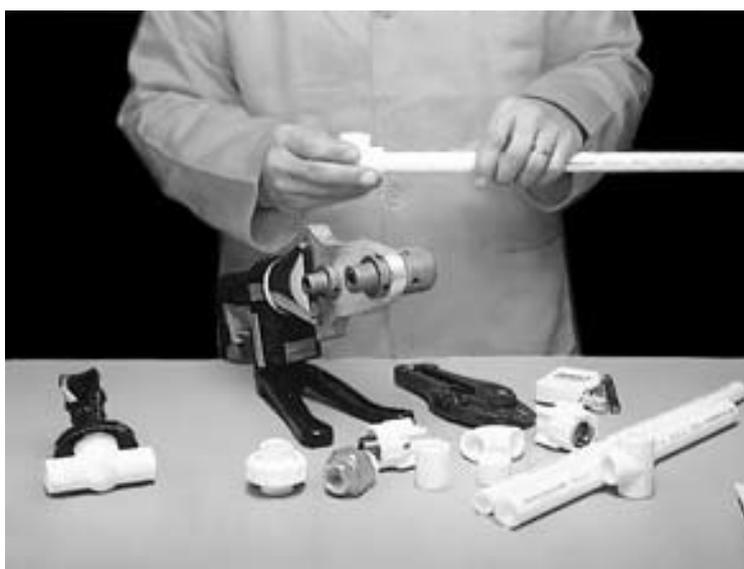
1. На сварочный аппарат устанавливаются насадки соответствующего диаметра, при этом рабочие поверхности насадок должны быть обезжирены ацетоном или водным раствором спирта. В случаях налипания на насадки
