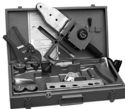
Для сварки пластмассовых деталей диаметрами больше 40 мм используют специальный сварочный аппарат, который поставляется в специальном чемоданчике. Общий вид сварочного аппарата (мощностью 1500 Вт) представлен на рисунке.
